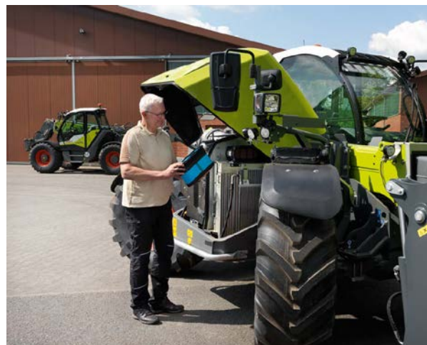
メンテナンスポイントに簡単にアクセスできる一体型ボンネット
